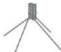
Анкерне кріплення в ґрунт
