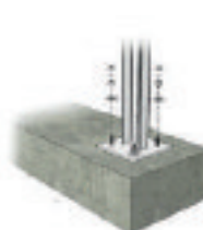
Встановлення на бетонні блоки
