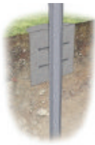
Забивання із бетонуванням
