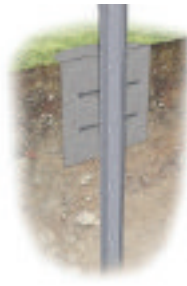
Забивання із бетонуванням
