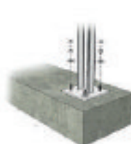
Встановлення на бетонні блоки
