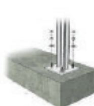
Встановлення на бетонні блоки
