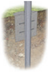
Забивання із бетонуванням
