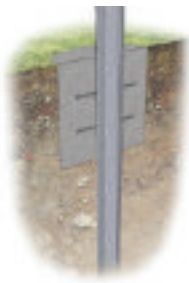
Забивання із бетонуванням
