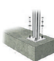
Встановлення на бетонні блоки
