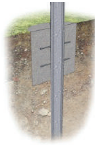
Забивання із бетонуванням
