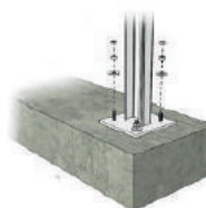
Встановлення на бетонні блоки
