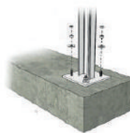
Встановлення на бетонні блоки
