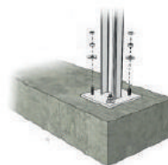
Встановлення на бетонні блоки
