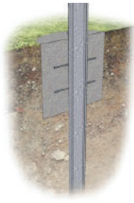
Забивання із бетонуванням
