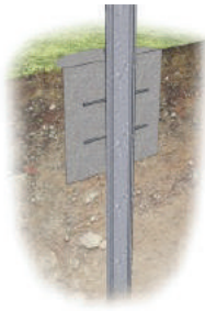
Забивання із бетонуванням
