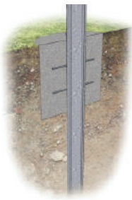
Забивання із бетонуванням
